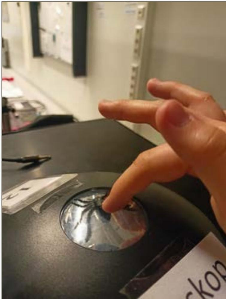
Stell das Miraskop vor dich und blicke auf die große Öffnung. Die Spinne schwebt mitten in der Öffnung! Wenn du versuchst, nach der Spinne zu greifen, fasst du durch sie hindurch.
