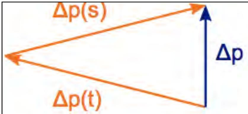
Führt man diese Berechnung für andere Positionen der Kugel durch, erhält man ebenfalls stets einen Impuls auf den Fokuspunkt zu. Die Kugel wird also dort eingefangen und kann durch eine Bewegung dieses Punktes verschoben werden.
