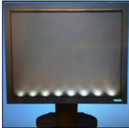
Für eine gute Hintergrundbeleuchtung gibt es im unteren Teil des Displays eine Reihe von Lampen, beispielsweise LEDs.
