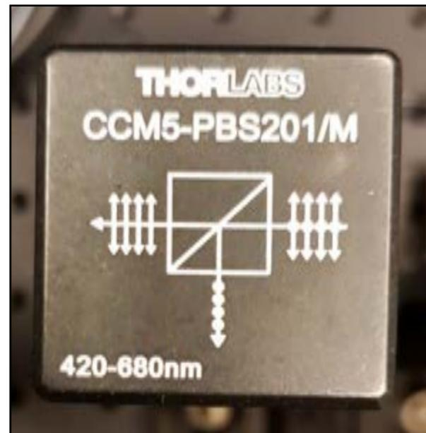
Das ist der Strahlteiler aus dem Experiment:
